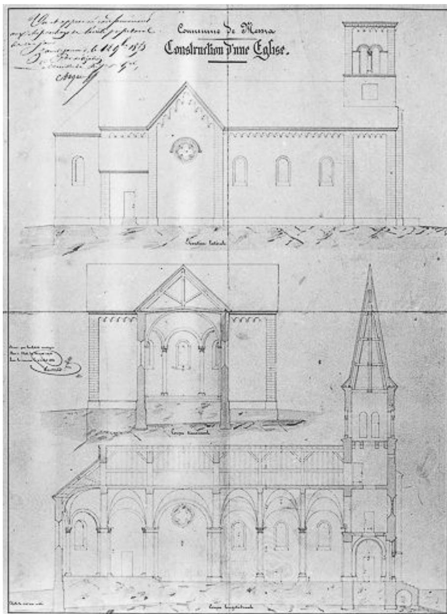
Elévation latérale, coupe transversale et coupe longitudinale.
