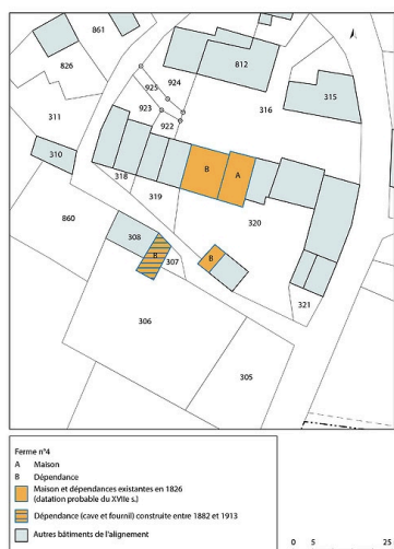
Plan de masse et de situation de la ferme n°1 de l'alignement de Mans, présentant l'évolution des bâtiments. Extrait du plan cadastral, 2020, section A, échelle 1/2500 Dess. Pierre-Marie Barbe-Richaud IVR26_20207100132NUDA
