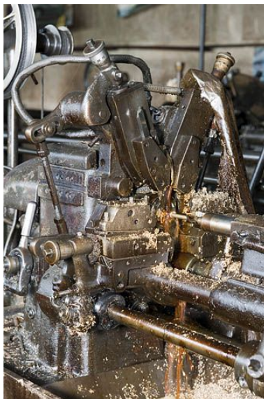
Atelier primitif. Machine à décolleter en action. Phot. Jérôme Mongreville IVR43_20112501472NUC4A
