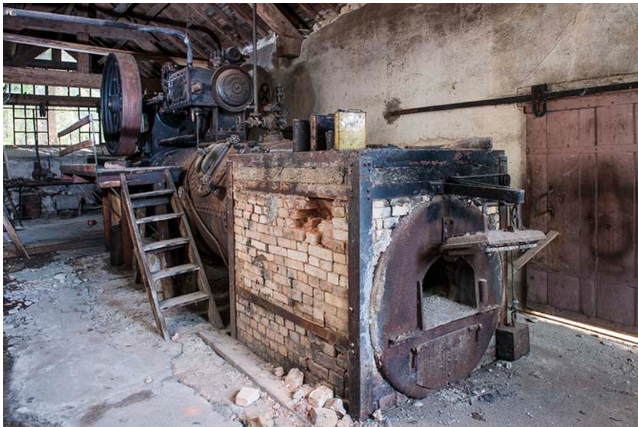
Scierie des Mortes, à Chapelle-des-Bois : machine à vapeur King et Cie.
