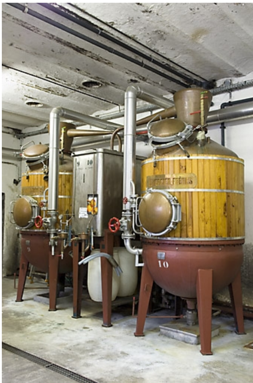
Atelier de distillation. Deux alambics Tournaire.
