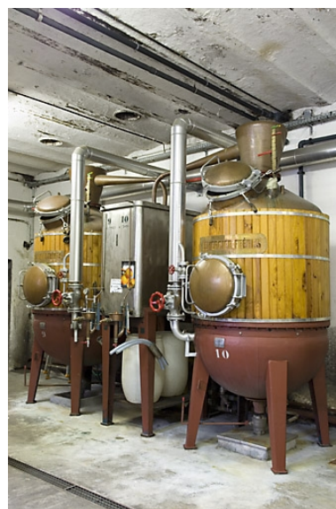
Atelier de distillation. Deux alambics Tournaire. Phot. Jérôme Mongreville IVR43_20077000125NUCA
