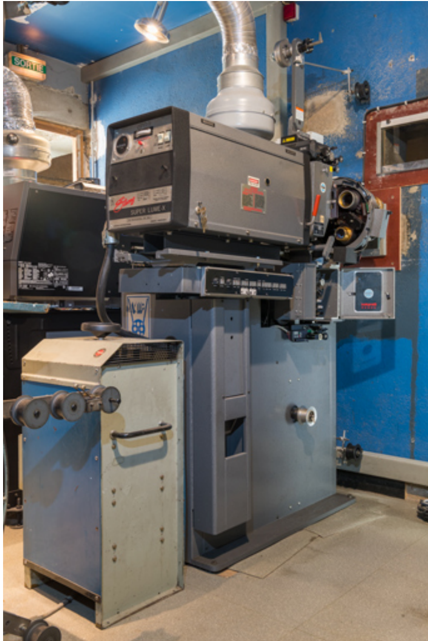
Projecteur Simplex et redresseur Prevest, de trois quarts arrière droit.
