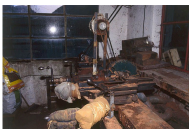
Machine à fraiser dite machine à aplatir. Phot. Jérôme Mongreville IVR43_20003901063ZA
