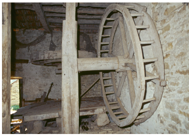
La roue à écureuil. Phot. Jean-Luc Duthu IVR26_20028900406ZA
