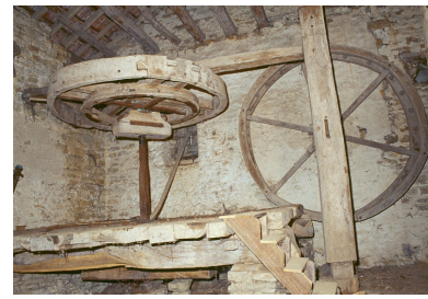
La maie, la roue de presse et la roue à écureuil. Phot. Jean-Luc Duthu IVR26_20028900399ZA
