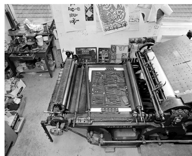
Vue plongeante sur la partie avant de la machine. De gauche à droite : système d'encrage (encrier, table d'encrage et rouleaux encreurs), marbre portant
