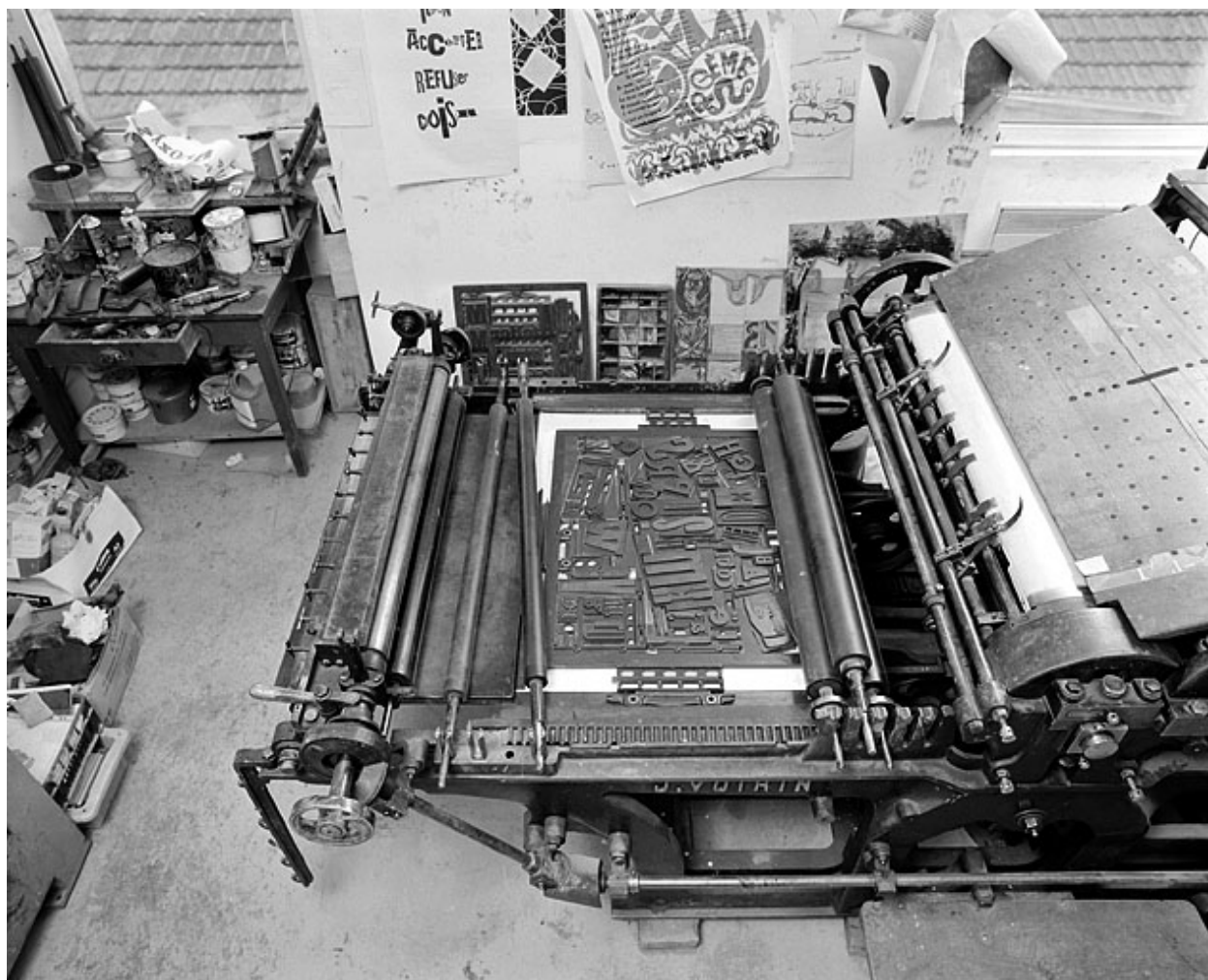
Vue plongeante sur la partie avant de la machine. De gauche à droite : système d'encrage (encrier, table d'encrage et rouleaux encreurs), marbre portant une forme et sa composition, cylindre et table de marge.
