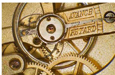
Mécánisme de réglage de la marche diurne : raquette sur le pont de balancier.
