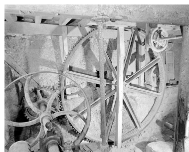
Rouet transmettant le mouvement de la roue extérieure. Phot. Jérôme Mongreville IVR43_19963901318X
