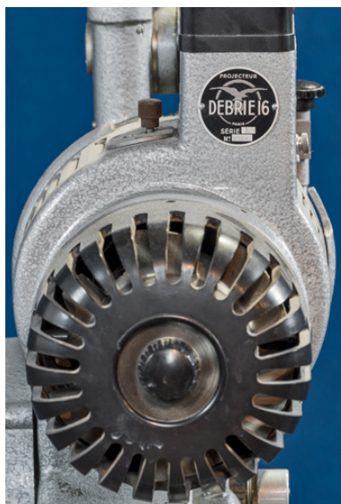
Arrière : moteur électrique et plaque signalétique. Phot. Pierre-Marie Barbe-Richaud IVR26_20257100445NUC4A
