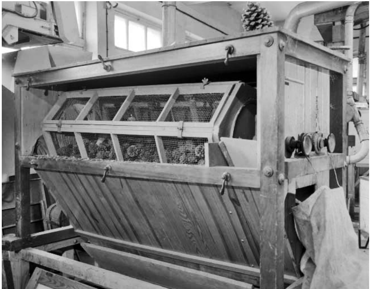
Détail du tambour chargé de cônes.
