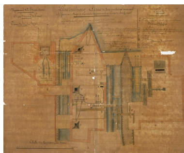
Plan intérieur de l'usine de Sceaux-sur-Saône consistant en haut fourneau, forges et laminoir [...]. Phot. Yves Sancey, Autr. Chevillet IVR43_19877000075XA
