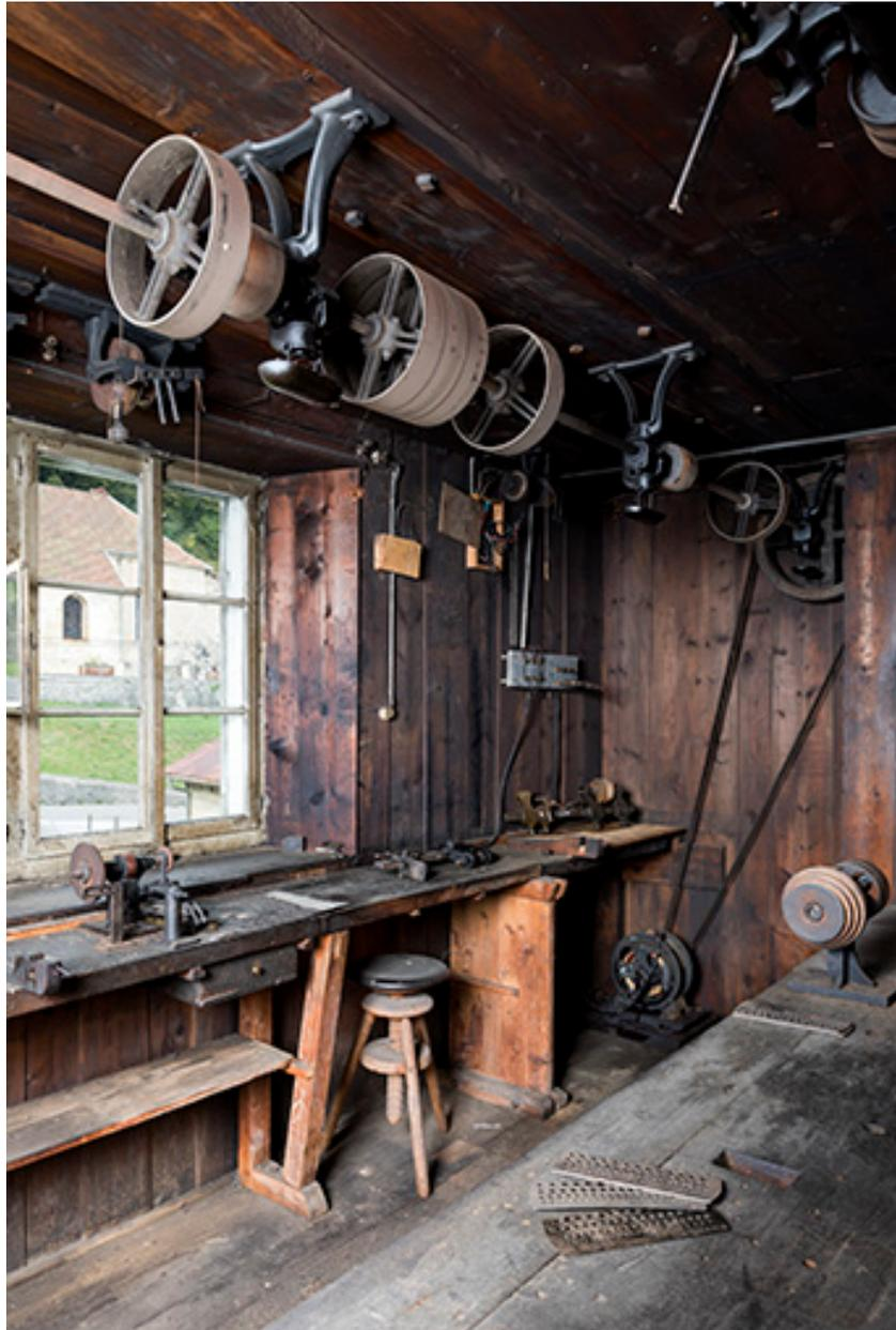
L'atelier, avec moteur électrique et transmissions.
