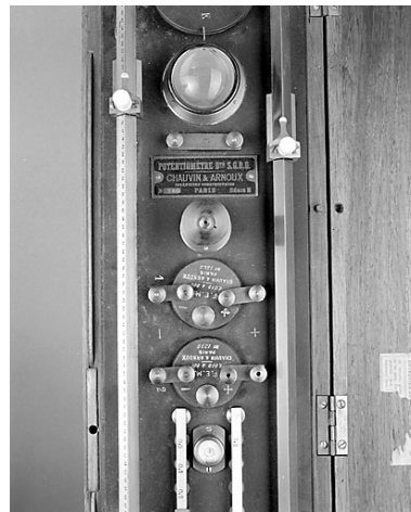
Partie gauche de l'appareil : galvanomètre, plaque du constructeur, piles et barrettes. Les deux thermomètres sont en place. Phot. Jérôme Mongreville IVR43_20023900216X
