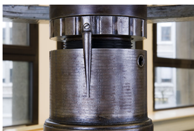
Graduations du système de réglage au dixième de mm. Phot. Marc Loukachine IVR43_20122500100NUC4A
