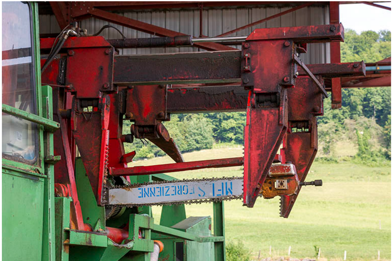
Parc aux grumes : bras de sciage de la scie Herkules.
