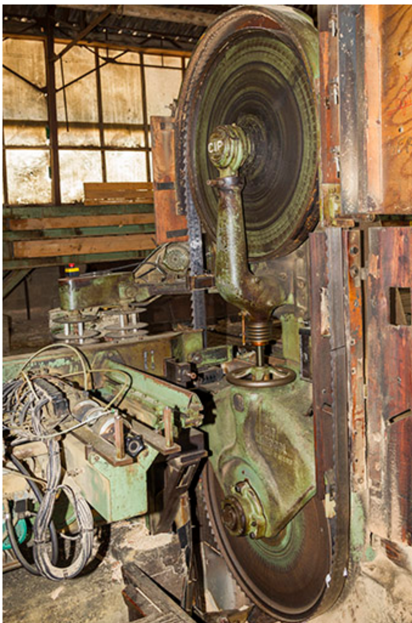
Atelier de fabrication de 1953 : volants et lame de la scie CIP Marqcol.
