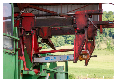
Parc aux grumes : bras de sciage de la scie Herkules. Phot. Yves Sancey IVR43_20132501286NUC2A
