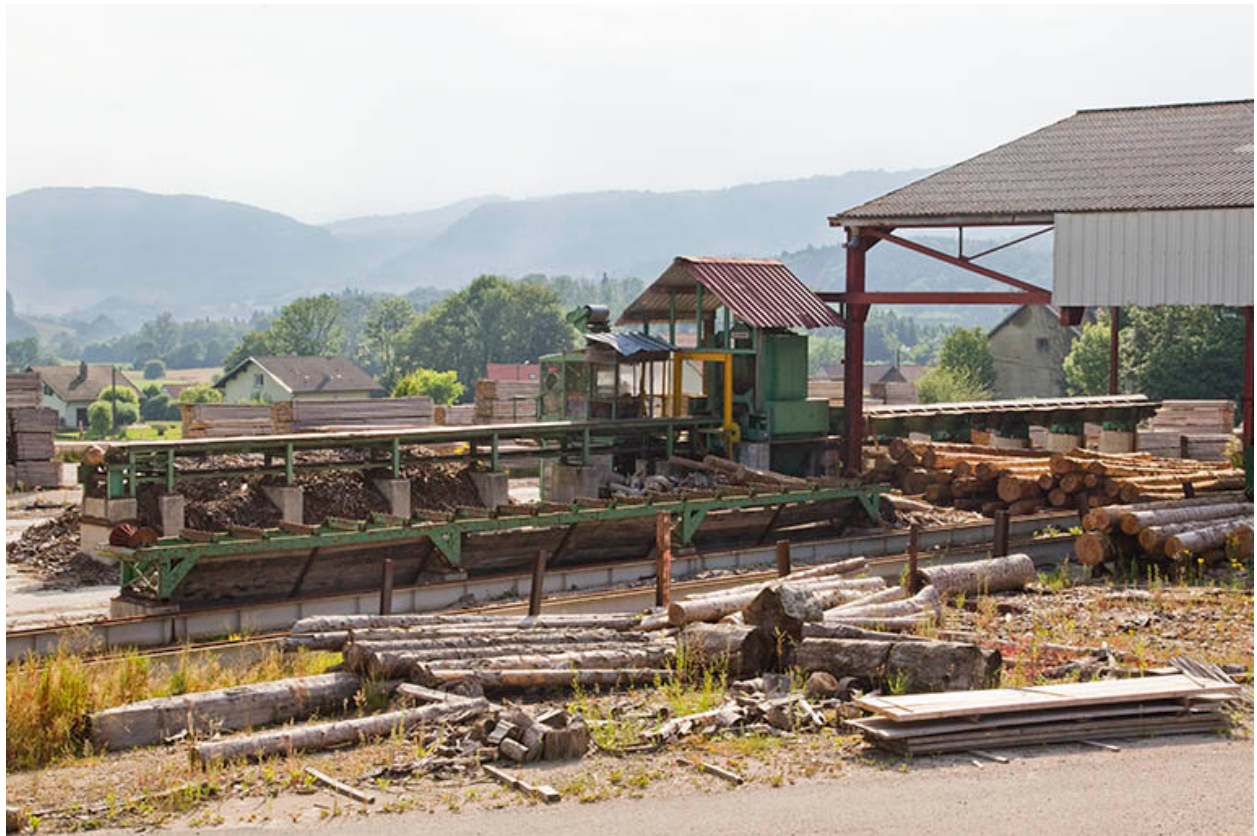
Parc aux grumes : convoyeur et écorceuse Segem.
