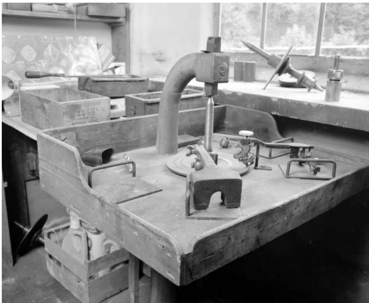
Banc de diamantaire. Près de la fenêtre, meule de diamantaire et pilon (pour fabriquer le bort).
