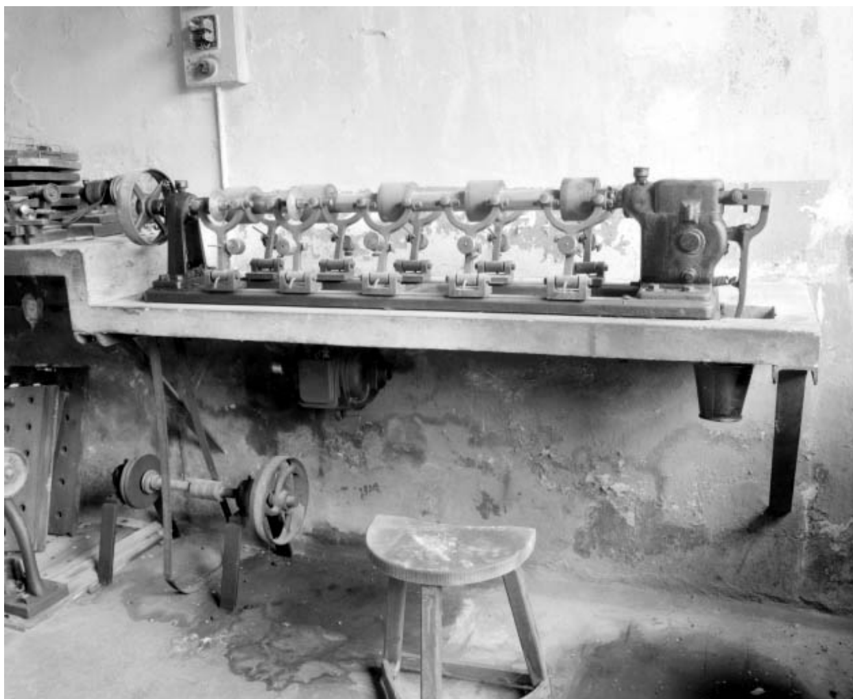
Machine à diamanter les lames de scie.
