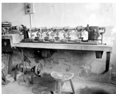
Machine à diamanter les lames de scie. Phot. Jérôme Mongreville IVR43_19923900454X
