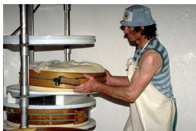
Chargement de la presse pneumatique. Phot. Jérôme Mongreville IVR43_19953900195ZA
