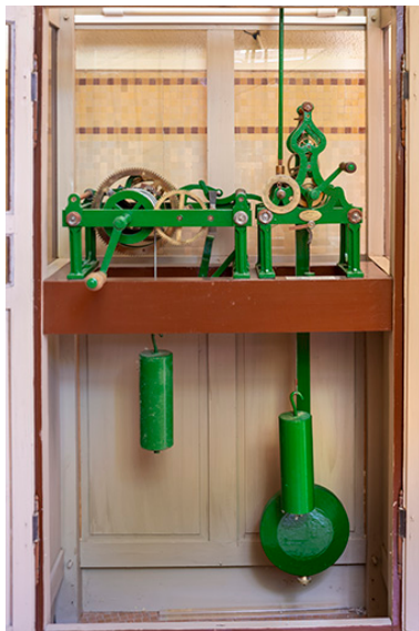
Vue du mécanisme avec ses poids et son balancier. Phot. Jérôme Mongreville IVR43_20207000249NUC4A
