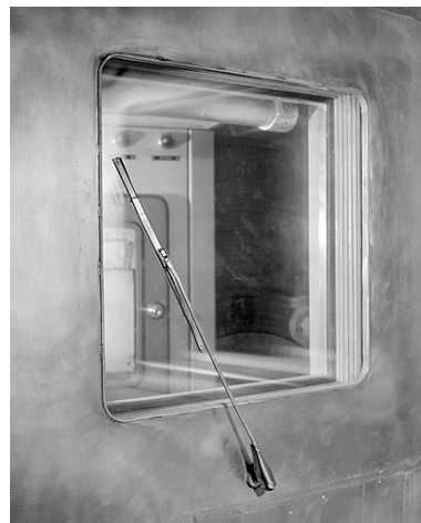
Enceinte d'essais : essuie-glace sur la face intérieure de la vitre. Phot. Jérôme Mongreville IVR43_20032501020X
