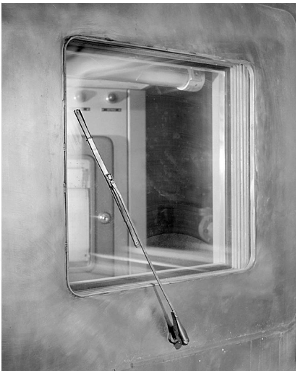
Enceinte d'essais : essuie-glace sur la face intérieure de la vitre.
