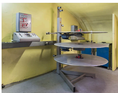
Pupitre à matrice à diodes et dérouleur à plateau Kinoton ST-270. Phot. Pierre-Marie Barbe-Richaud IVR26_20212100314NUC4A
