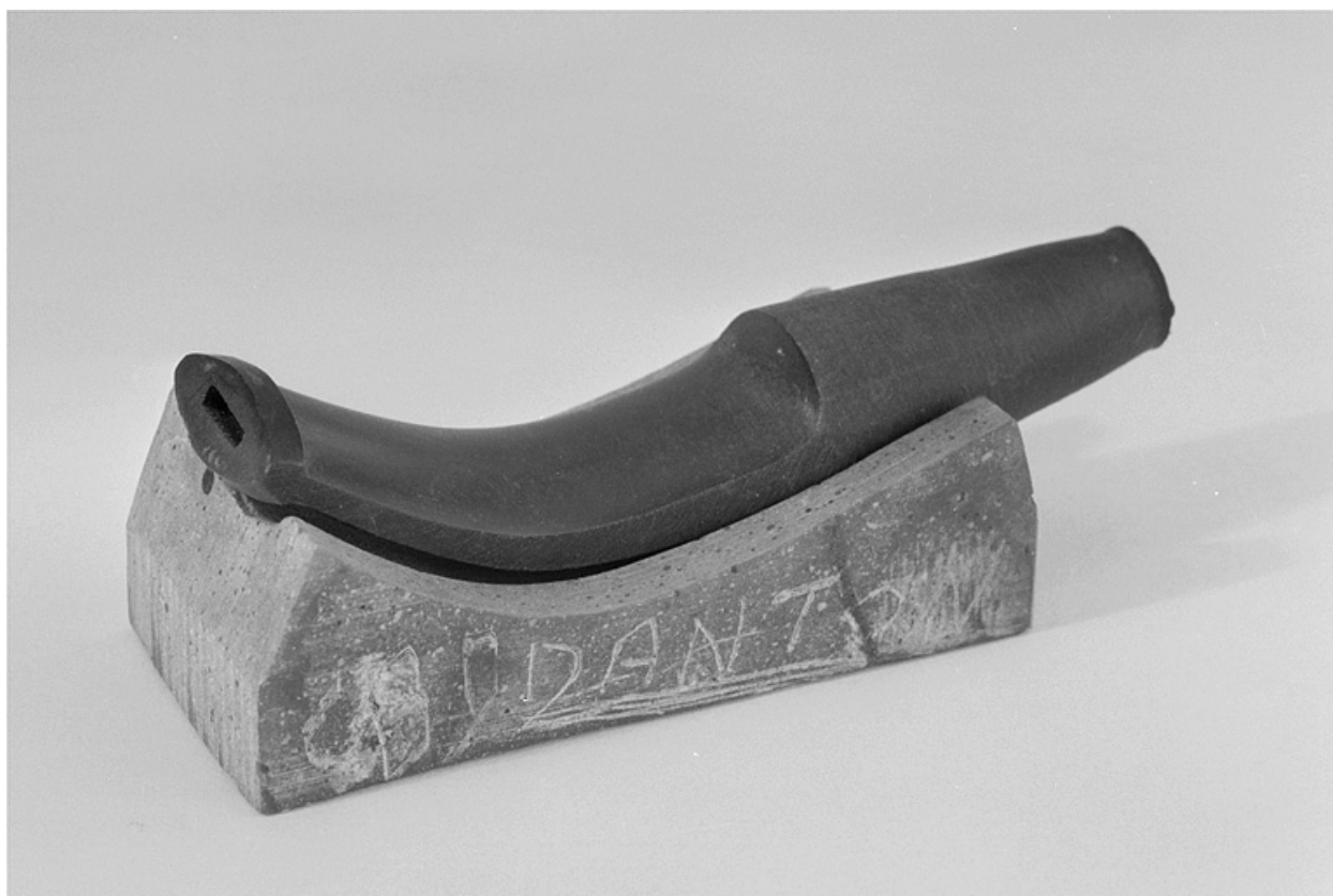
Détail d'un tuyau en ébonite moulé dans son marbre.
