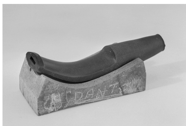
Détail d'un tuyau en ébonite moulé dans son marbre. Phot. Jérôme Mongreville IVR43_20022500941X
