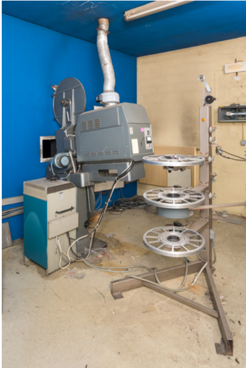
Redresseur Irem N3-X75/95DM, projecteur Cinemeccanica Victoria 8 r et enrouleur-dérouleur de film ST200.
