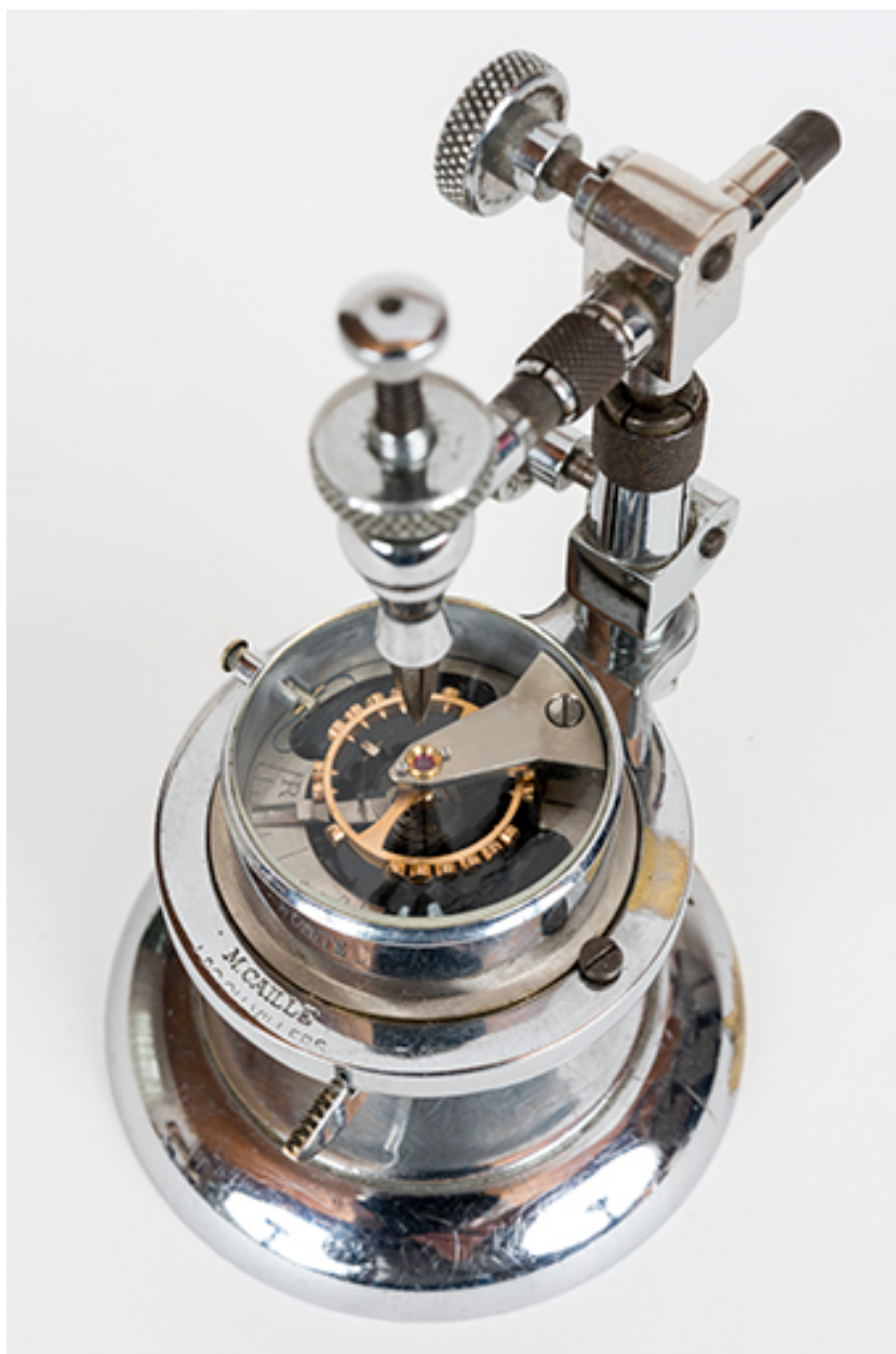
Vue plongeante montrant la boîte contenant le balancier-spiral étalon.
