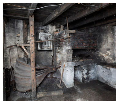
Forge : soufflet, foyer et établi (à droite). Phot. Sonia Dourlot IVR43_20192501343NUC4A
