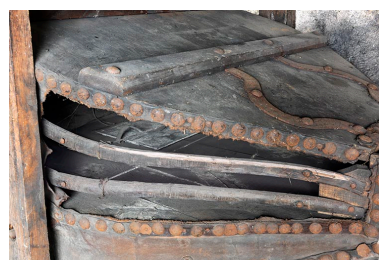
Forge : côté du soufflet en cuir, en mauvais état. Phot. Sonia Dourlot IVR43_20192501346NUC4A
