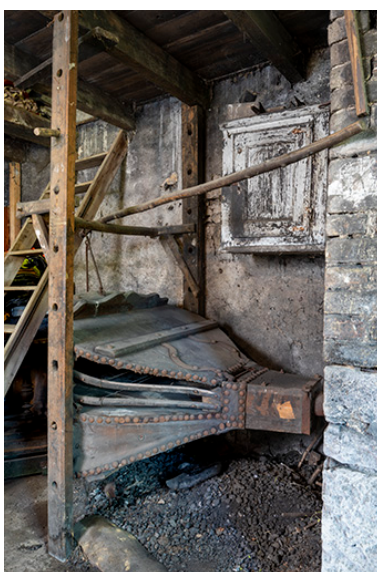
Forge : soufflet en cuir. Phot. Sonia Dourlot IVR43_20192501344NUC4A
