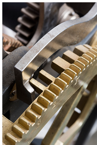
Mouvement, mécanisme des sonneries : système de la roue de compte.
