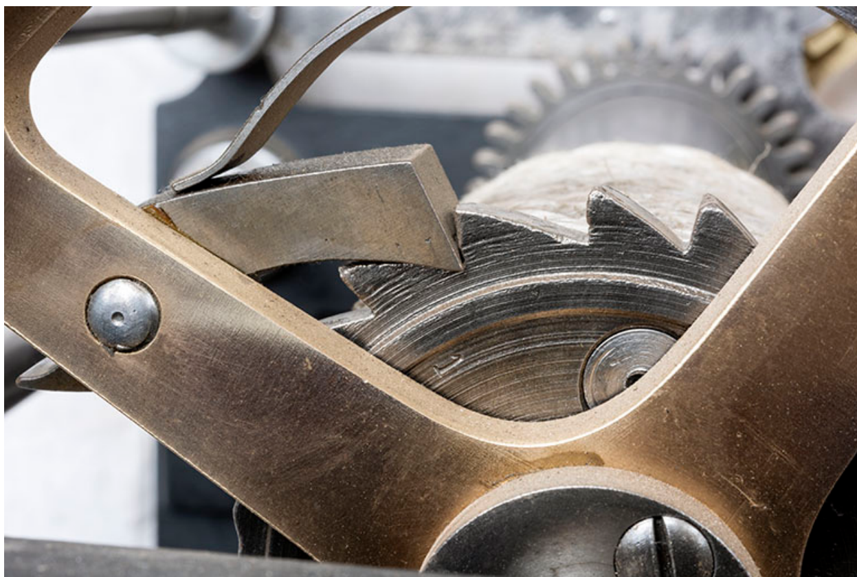
Mouvement, mécanisme des sonneries : détail du cliquet.
