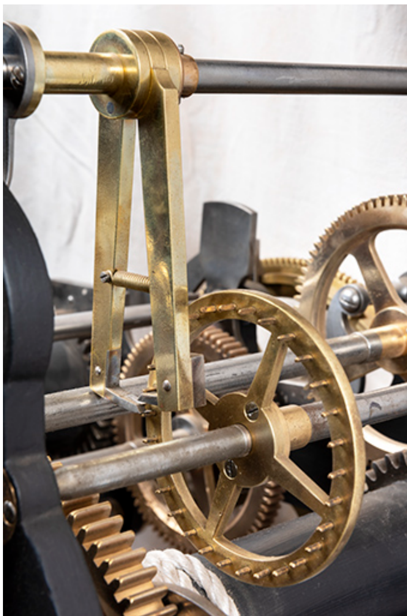
Mouvement, mécanisme des heures : échappement à chevilles.
