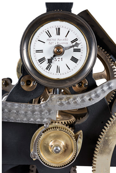
Mouvement, mécanisme des heures : cadran de contrôle et roue dentée. Phot. Sonia Dourlot IVR43_20182501651NUC4A
