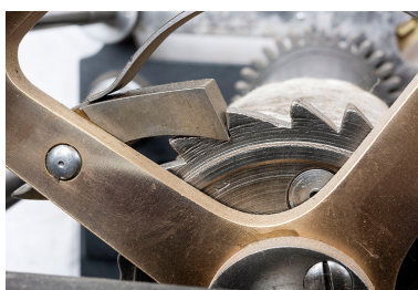
Mouvement, mécanisme des sonneries : détail du cliquet.
