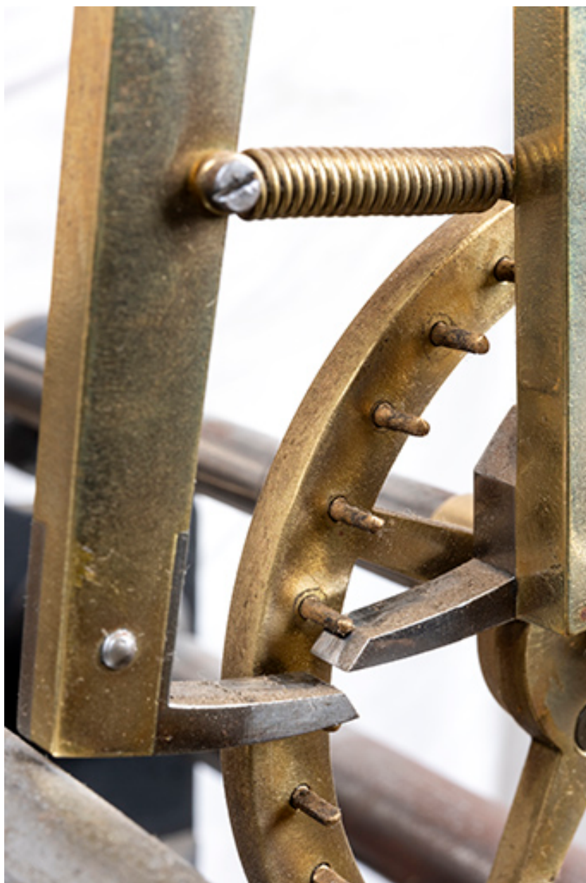
Mouvement, mécanisme des heures : échappement à chevilles (détail de l'ancre et des chevilles).
