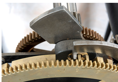
Mouvement, mécanisme des sonneries : système de la roue de compte.
