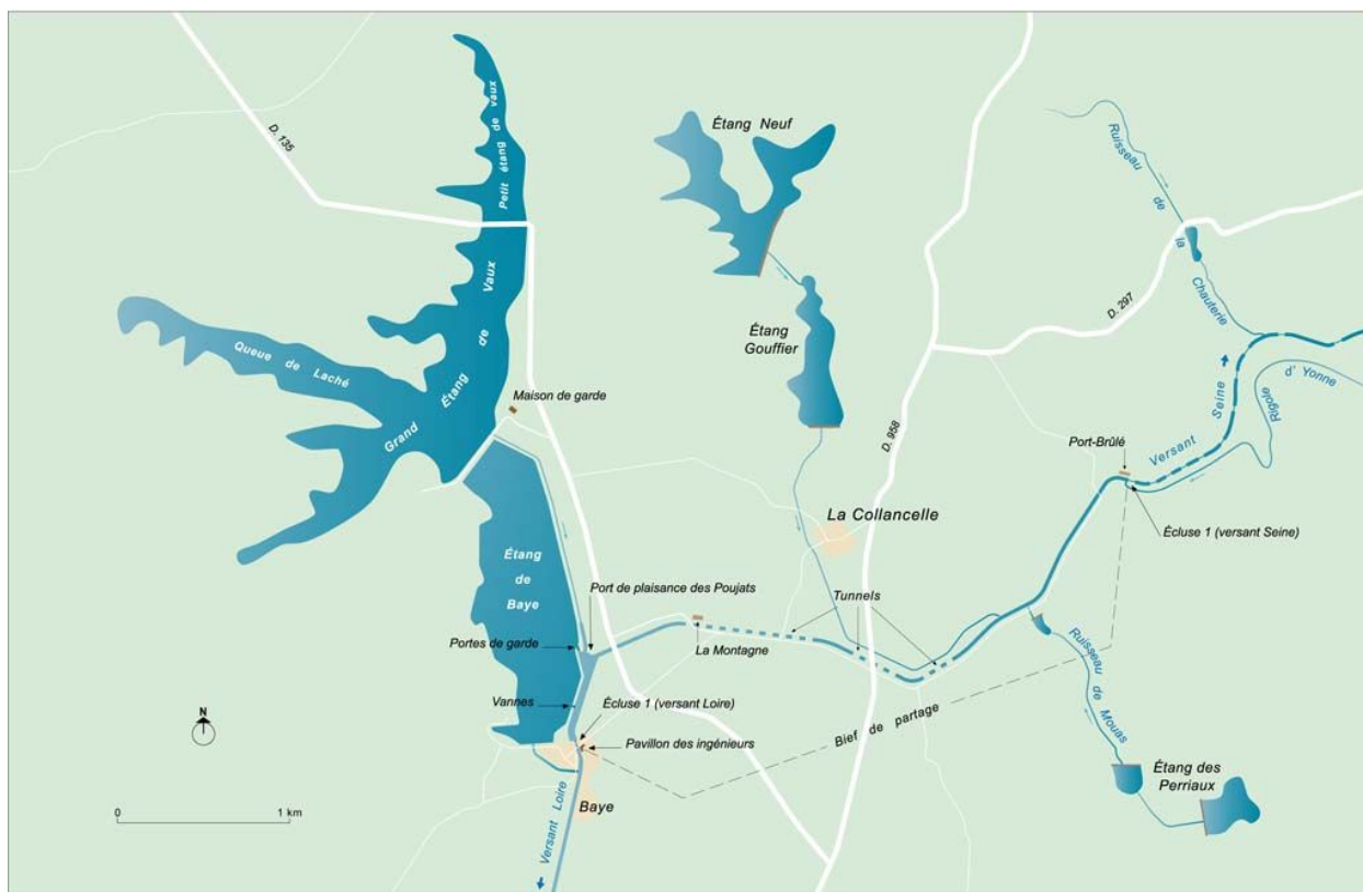
Carte schématique du bief de partage et des étangs-réservoirs qui l'alimentent.
