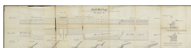
Élévation, plan et coupes des perrés et port à gradins à construire sur la rive gauche de la Saône à Losne. 1838. Phot. Petot Frédéric, Phot. IVR26_20202100107NUC4AQ
