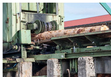
Détail du poste d'écorçage. Phot. Jérôme Mongreville IVR43_20152502390NUC4A
