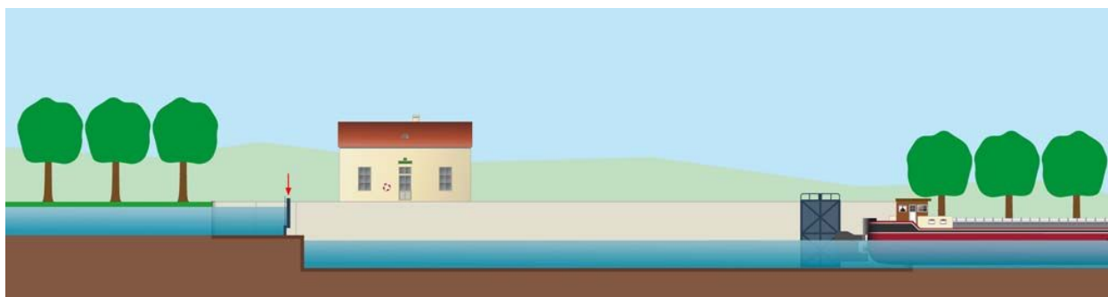
Schéma d'éclusage d'un bateau avalant, étape 10.
