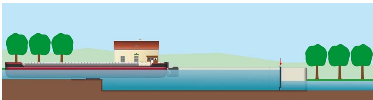
Schéma d'éclusage d'un bateau montant, étape 9.
