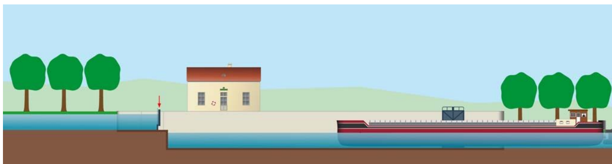
Schéma d'éclusage d'un bateau montant, étape 3.
