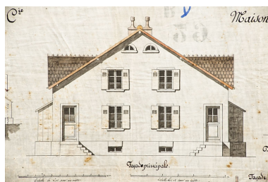
Cité Constant Peugeot et Cie. Maison à quatre logements. Façade principale. Plans, coupes, élévations, toile, lavis, échelles 1/50 et 1/100, s.d. [1870]. Phot. Jérôme Mongreville IVR43_20122501206NUC4A
