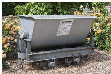
Wagonnet servant au transport du laitier vers le crassier, tiré par des locomotives "Decauville" (seul le châssis est d'origine). Phot. Jérôme Mongreville IVR43_20122501244NUC4A
