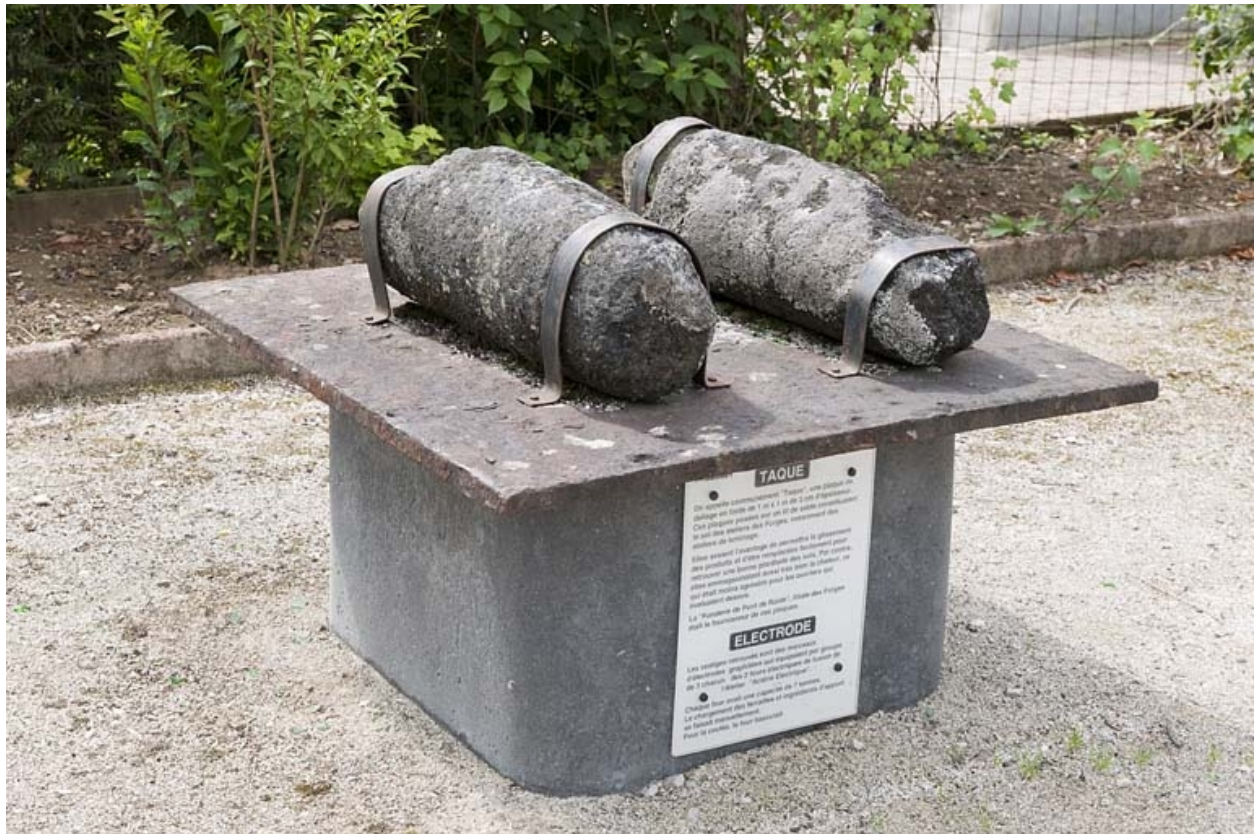
Pièces diverses exposées à proximité du site : électrodes des fours électriques posées sur une plaque de fonte (taque).
