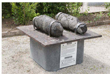
Wagonnet servant au transport du laitier vers le crassier, tiré par des locomotives "Decauville" (seul le châssis est d'origine). Phot. Jérôme Mongreville IVR43_20122501244NUC4A
