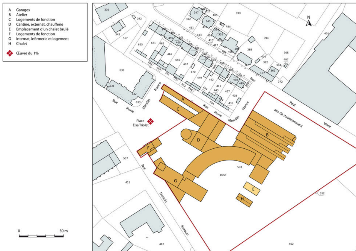
Plan-masse et de situation. Extrait du plan cadastral numérisé, section AR, échelle 1:1000.
