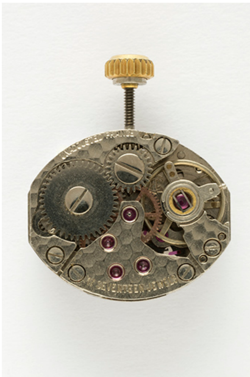
Mouvement France Ebauches FE 68-A : face côté ponts.
