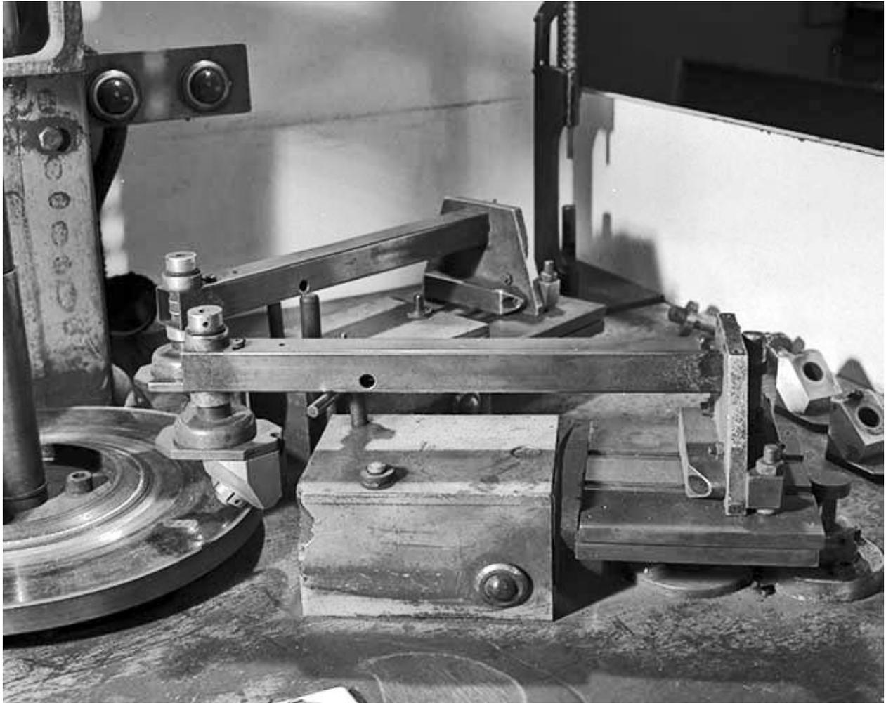
Pince mécanique (tenaille de lapidaire). La pince repose sur un boîtier qui va l'animer d'un mouvement de va-et-vient.
