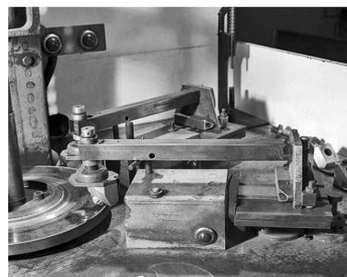
Pince mécanique (tenaille de lapidaire). La pince repose sur un boîtier qui va l'animer d'un mouvement de va-et-vient.
