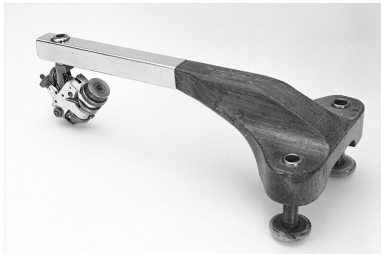
Pince mécanique (tenaille de lapidaire), vue du côté du diamantaire. Phot. Jérôme Mongreville IVR43_20023900038X
