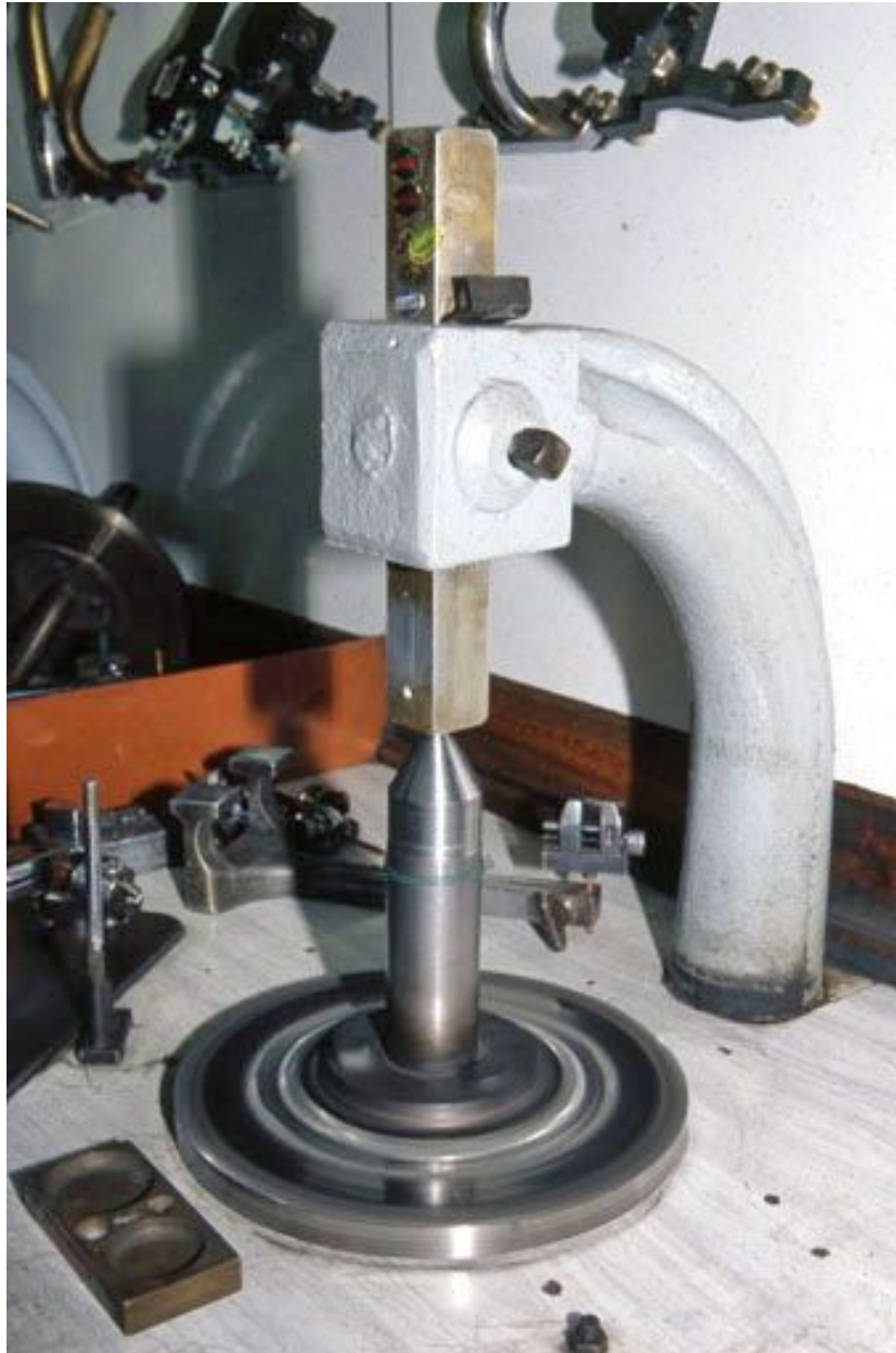
Meule et son système de fixation.
