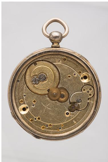
Montre de gousset de la fin du 18e siècle ou du début du 19e siècle : côté cadran (cadran, aiguilles et glace manquent). Noter les traits de compas du planteur de finissage qui a pointé l'emplacement des mobiles (par exemple celui de la roue des secondes, près du centre).
