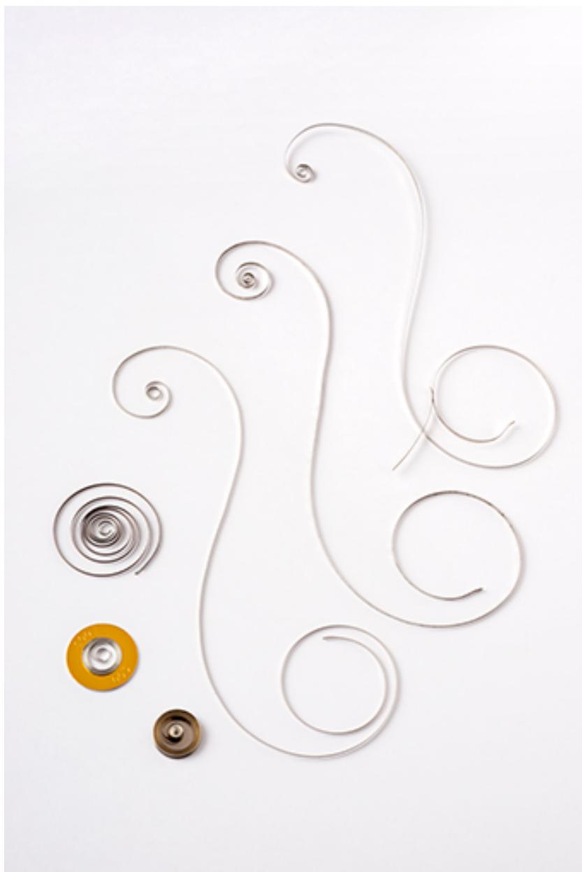
Barillet démonté et ressorts moteurs.
