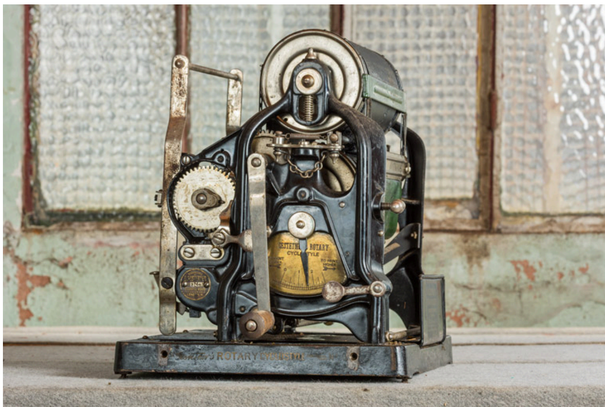
Face droite : poignée d'entraînement des cylindres et indicateur de pression.
