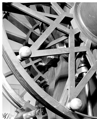
Cercle de mesure avec poignées en bois pour les manoeuvres. Phot. Jérôme Mongreville IVR43_20042500062X
