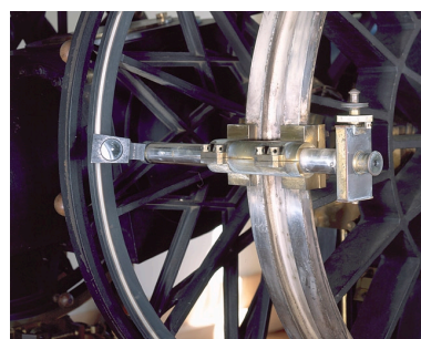
L'un des six microscopes équipant chacun des deux cercles gradués. Phot. Jérôme Mongreville IVR43_20042500017VA
