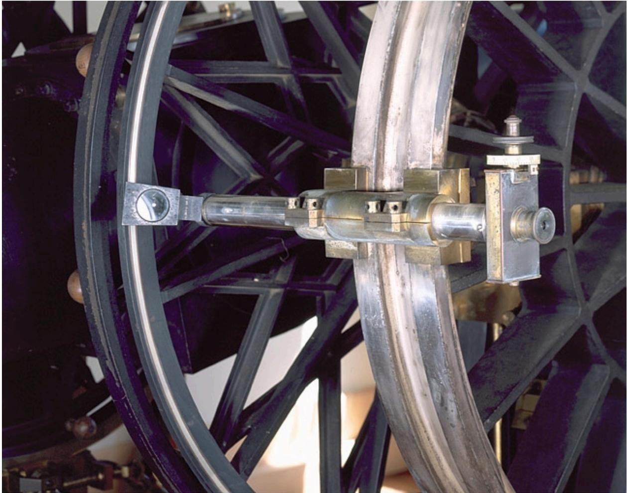
L'un des six microscopes équipant chacun des deux cercles gradués.
