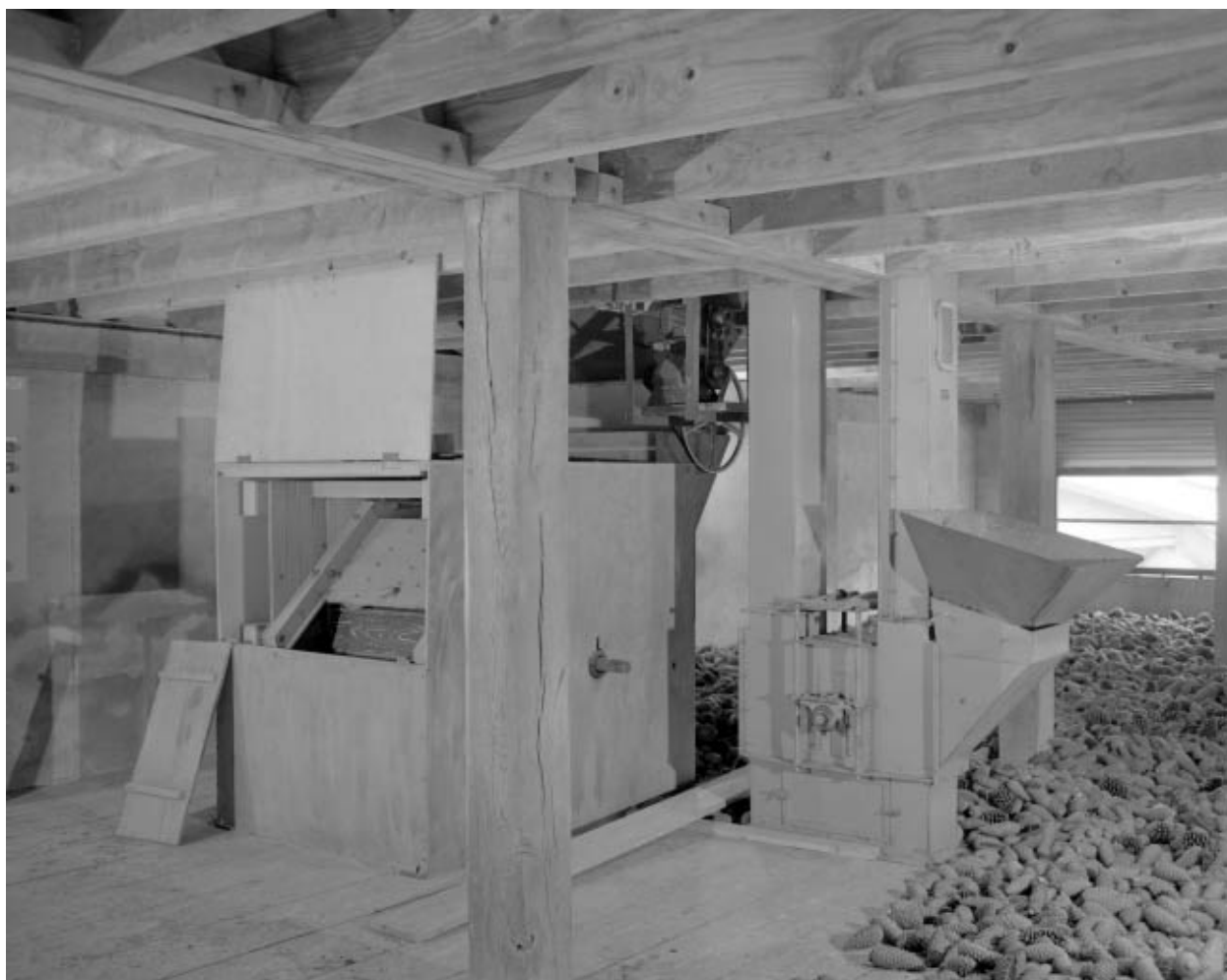
Vue d'ensemble. Batteur et élévateur à godets.
