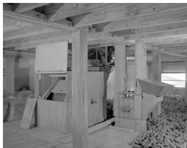
Vue d'ensemble. Batteur et élévateur à godets. Phot. Jérôme Mongreville IVR43_19973900298X
