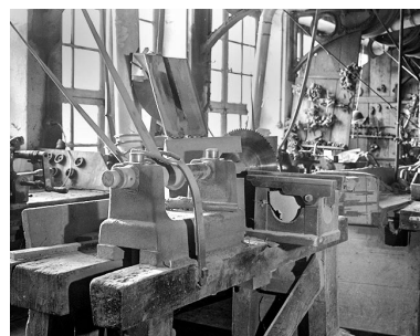
Atelier d'ébauchage : scie circulaire. Phot. Jérôme Mongreville IVR43_19913900534X
