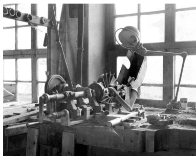
Atelier d'ébauchage : machine à fraiser. Phot. Jérôme Mongreville IVR43_19913900536X
