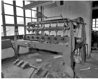
Machine à sculpter et à râper ACIMALL "la Scolpitrice". Pantographe avec palpeur central et 6 fraises. Phot. Jérôme Mongreville IVR43_19913900538X
