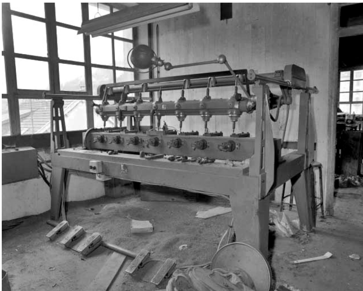
Machine à sculpter et à râper ACIMALL "la Scolpitrice".Pantographe avec palpeur central et 6 fraises.
