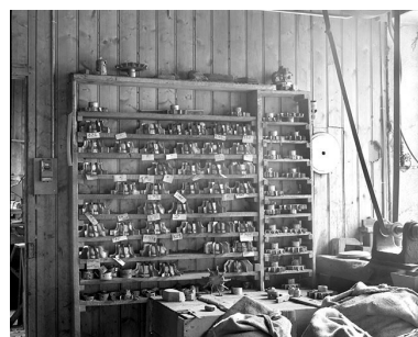
Atelier de mécanique : fraises pour l'ébauchage. Phot. Jérôme Mongreville IVR43_19913900531X
