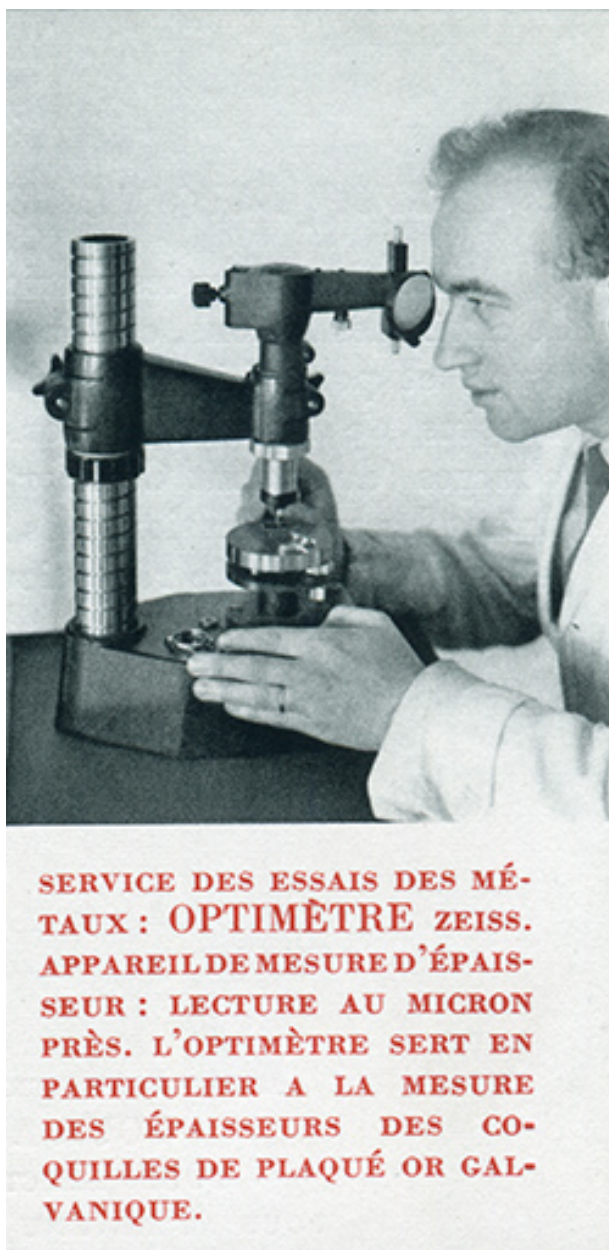
Service des essais des métaux. Appareil de mesure d'épaisseur (optimètre Zeiss), 1955.
