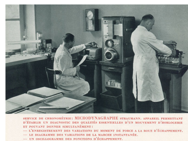
Service de chronométrie. Microdynamographe (diagnostic des mouvements), 1955. Phot. Meusy IVR43_20182500643NUC4A
