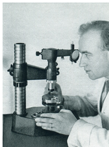
SERVICE DES ESSAIS DES MÉ- TAUX : OPTIMÈTRE ZEISS. APPAREIL DE MESURE D'ÉPAIS- SEUR : LECTURE AU MICRON PRÈS. L'OPTIMÈTRE SERT EN PARTICULIER A LA MESURE DES ÉPAISSEURS DES CO- QUILLES DE PLAQUÉ OR GAL- VANIQUE.
