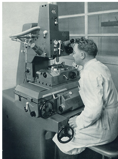
Atelier de mécanique. Machine à pointer (usinage des pièces), 1955. Phot. Meusy IVR43_20182500652NUC4A
