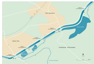
Carte schématique de l'alimentation de l'échelle d'écluses d'Ecuisses. Dess. Alain Morelière IVR26_20147100005NUDA
