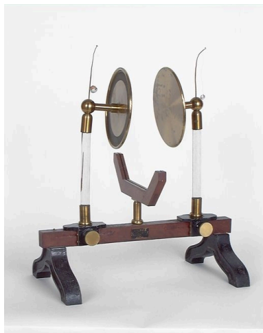
Premier condensateur. Phot. Michel Thierry IVR26_20002100264NUCA
