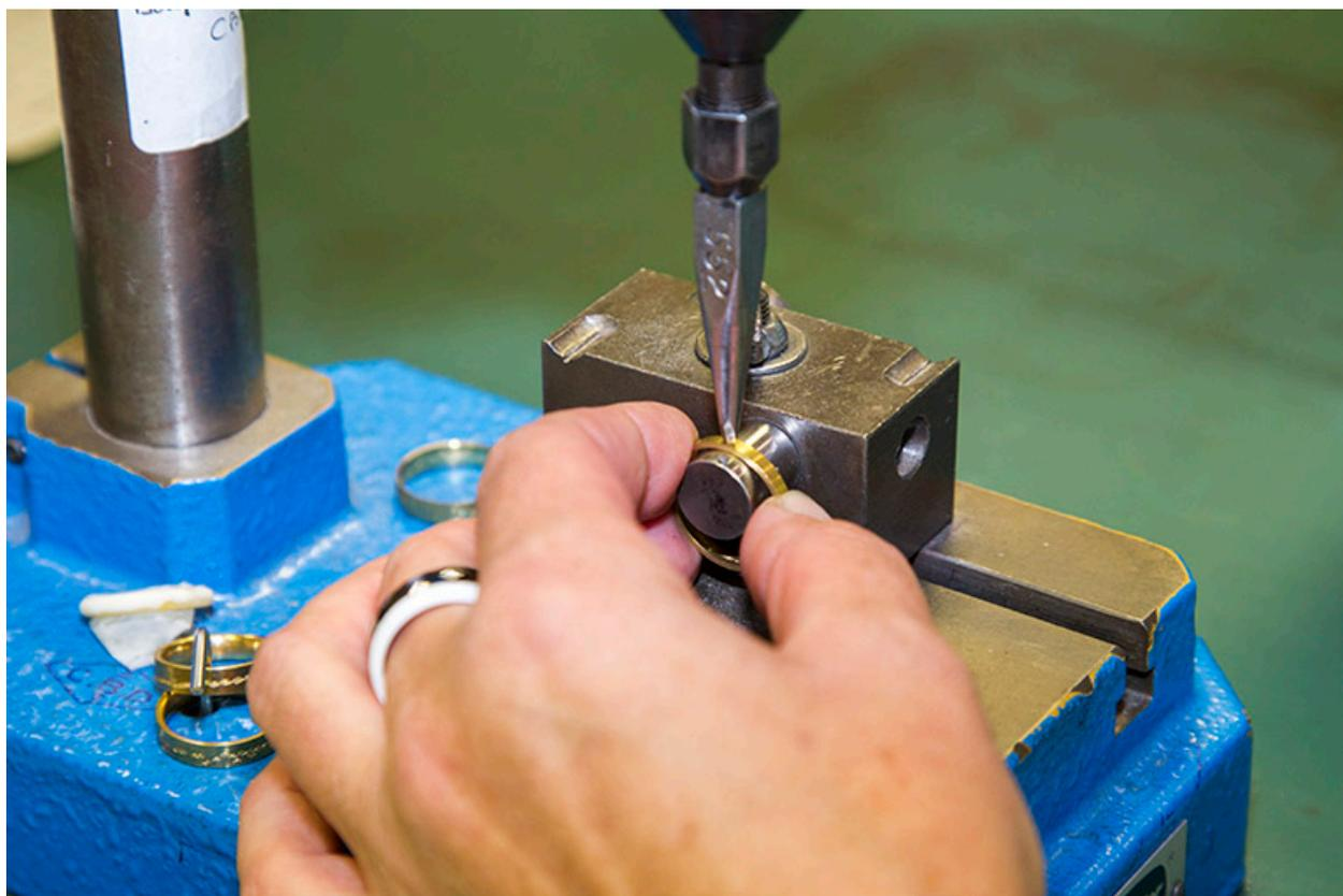
Atelier de poinçonnage : poinçonnage d'une alliance (vue rapprochée).
