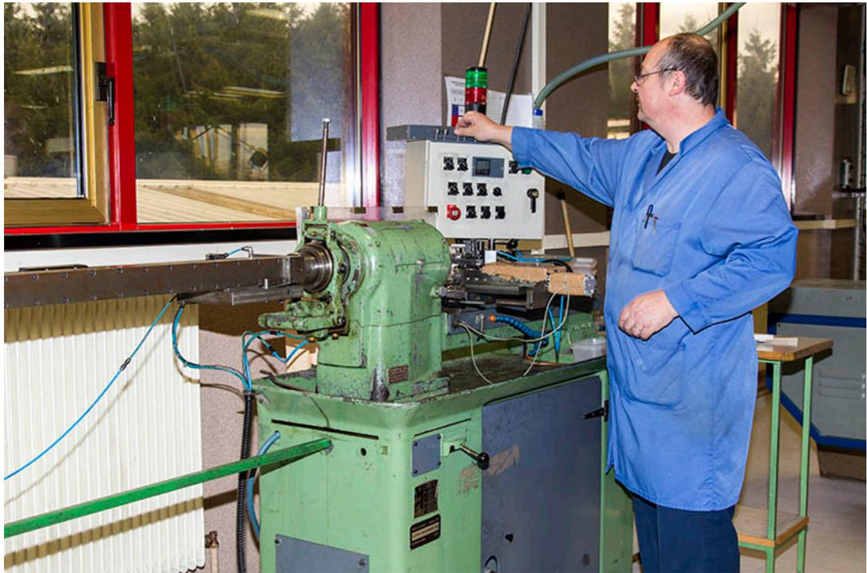
Usinage : découpe d'un tube pour obtenir une " rondelle ".
