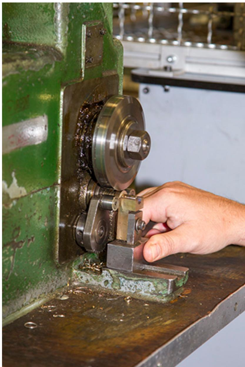
Usinage : laminage de la rondelle (vue rapprochée).
