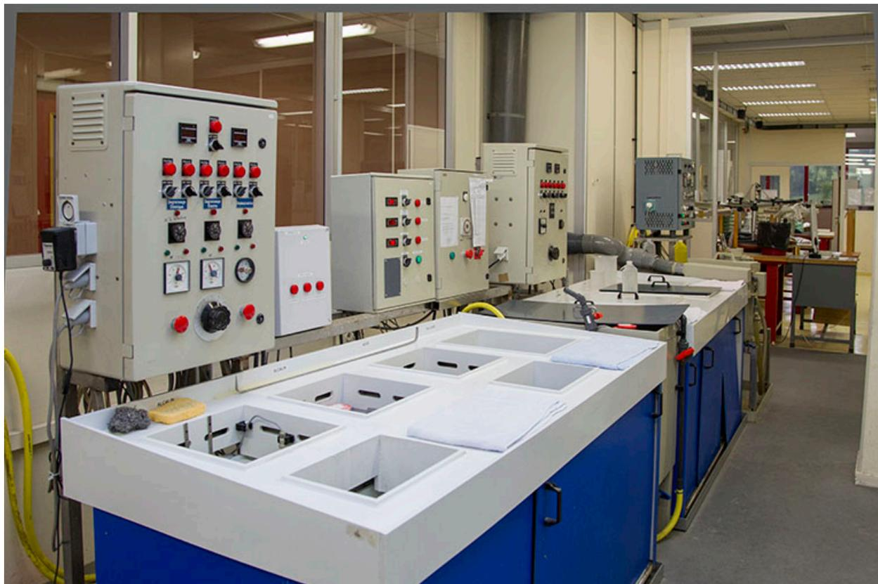
Atelier de traitement de surface : installation de galvanoplastie.
