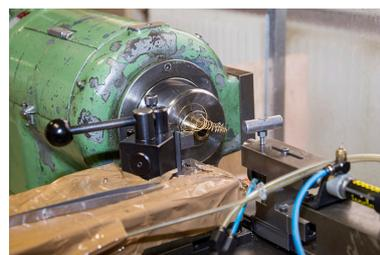
Usinage : partie travaillante de la machine lors de la découpe d'un tube.
