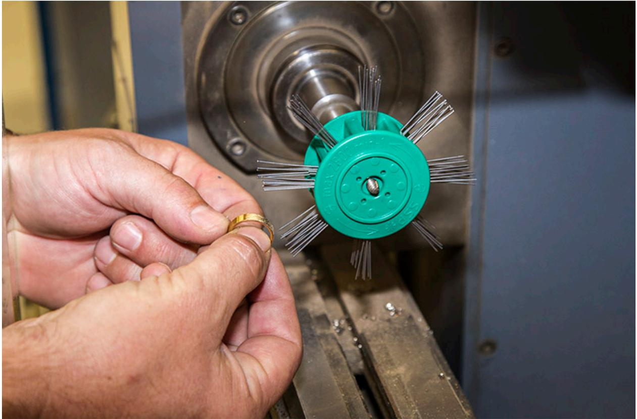
Usinage : surfaçage d'une rondelle (pour obtenir un aspect brossé, toilé, etc.).
