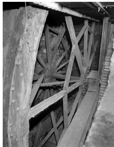
Détail de la charpente de la roue hydraulique. Phot. Yves Sancey IVR43_19973901237X
