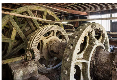
Arbre de couche couplé à la roue hydraulique. Au premier plan, couronne porte cames. Phot. Jérôme Mongreville IVR43_20152501532NUC4A
