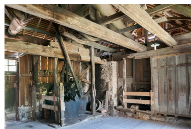
Pièce de la machine soufflante. En partie inférieure, système de transmission par bielle. Phot. Jérôme Mongreville IVR43_20152501581NUC4A
