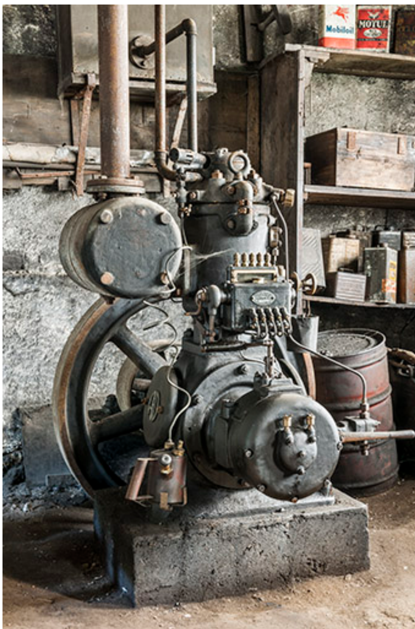
Atelier de mécanique. Moteur semi-diesel Douge.
