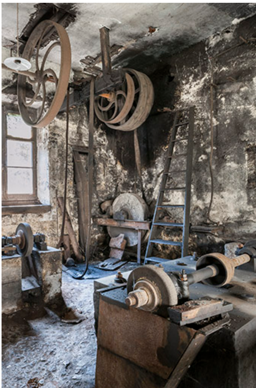
Atelier de mécanique. Transmission aérienne et polissoirs.
