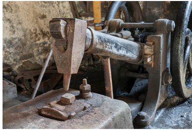
Atelier de mécanique. Détail de la tête du martinet de finition. Phot. Jérôme Mongreville IVR43_20152501548NUC4A
