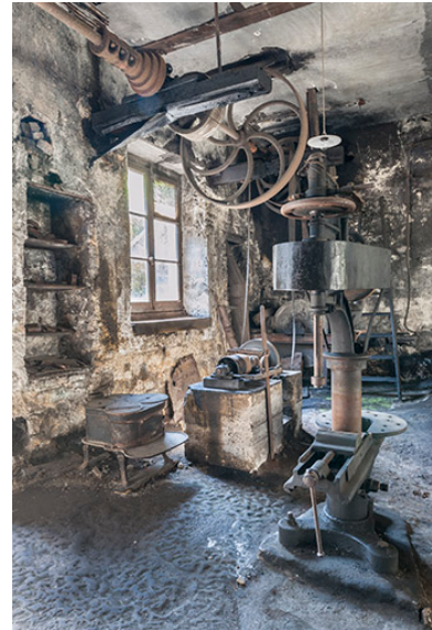
Atelier de mécanique : transmission aérienne, poêle, polissoir et perceuse à colonne. Phot. Jérôme Mongreville IVR43_20152501551NUC4A
