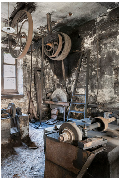
Atelier de mécanique. Transmission aérienne et polissoirs. Phot. Jérôme Mongreville IVR43_20152501553NUC4A
