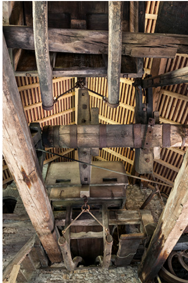
Mécanisme de bascule du soufflet double (caisson sud en position basse). Phot. Jérôme Mongreville IVR43_20152501579NUC4A
