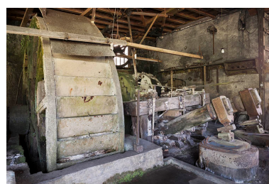
Roue hydraulique et les deux martinets ouest. Phot. Jérôme Mongreville IVR43_20152501529NUC4A
