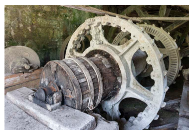
Arbre de couche de la roue hydraulique. Au second plan, roue dentée actionnant un polissoir. Phot. Jérôme Mongreville IVR43_20152501531NUC4A
