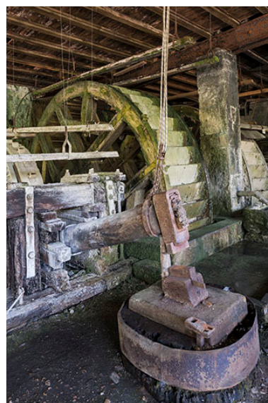
Le martinet est : le bras (ou manche) et la tête. Au sol : la chabotte et l'enclume. Phot. Jérôme Mongreville IVR43_20152501534NUC4A
