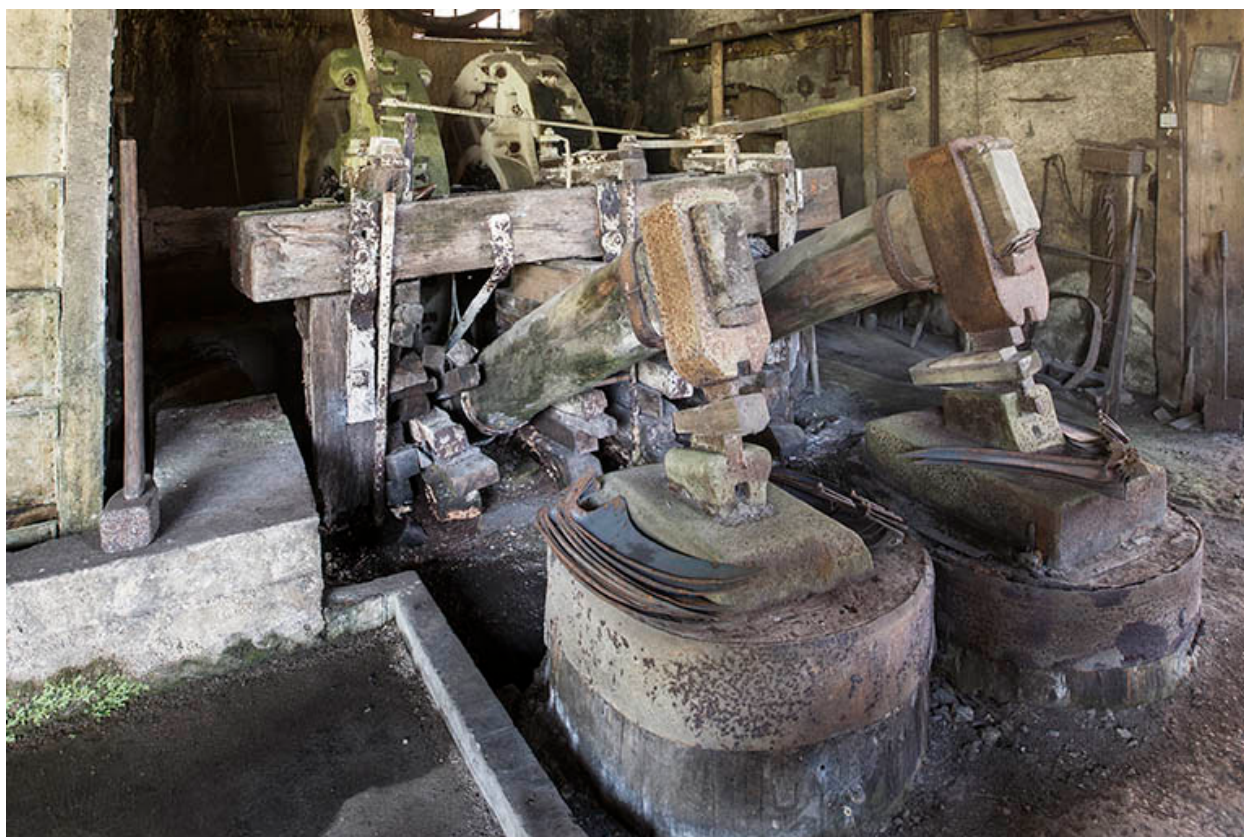
Vue d'ensemble des martinets ouest.
