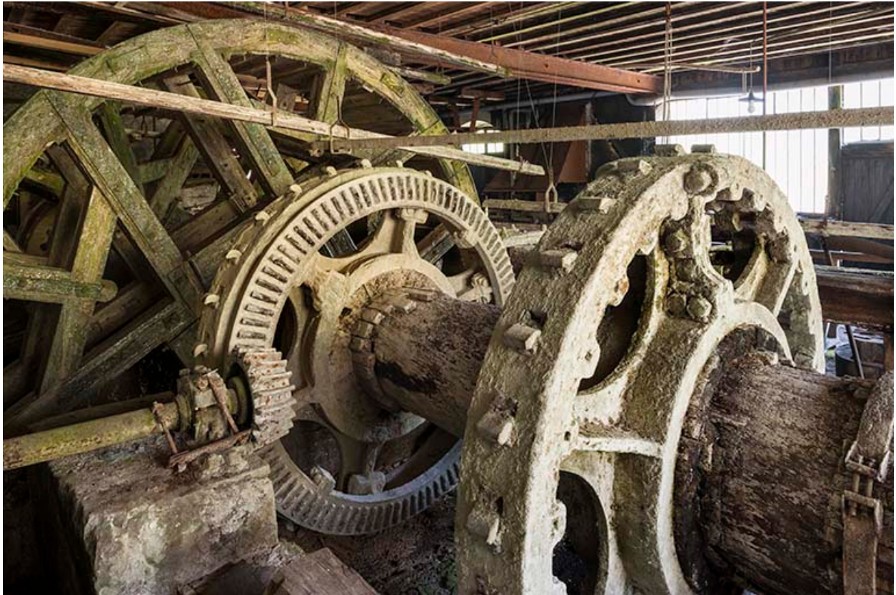
Arbre de couche couplé à la roue hydraulique. Au premier plan, couronne porte cames.
