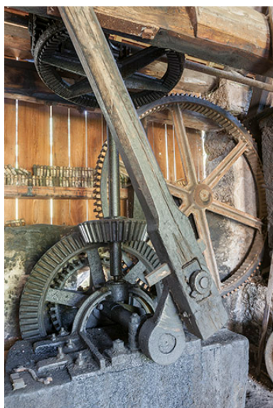
Mécanisme de transmission par bielle. Phot. Jérôme Mongreville IVR43_20152501574NUC4A
