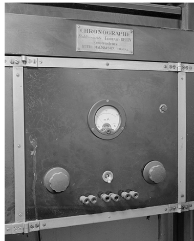
Plaque, cadran de l'ampèremètre et boutons de réglage. Phot. Jérôme Mongreville IVR43_20032501066X
